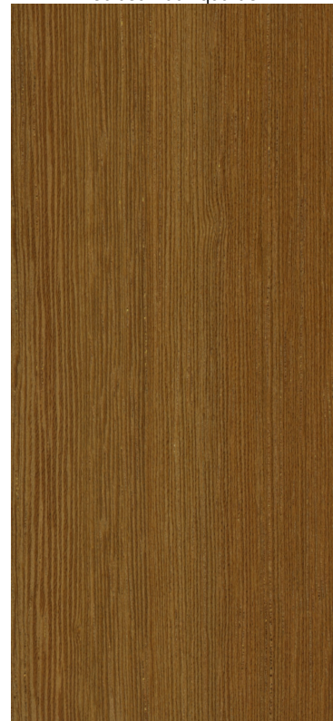
Débit sur faux quartier
